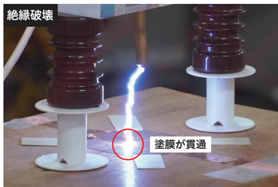
絶縁破壊時の放電様相
