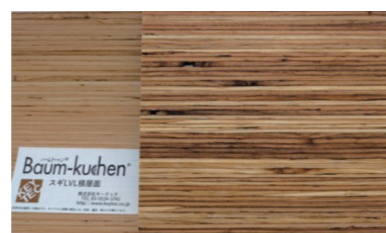
触感付与や耐久性向上を目的としたバイオペイントの塗装例(素材は建築用の木材合板)
