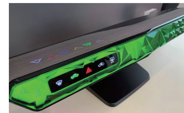
型内塗装での塗装品(天面の光沢箇所)
