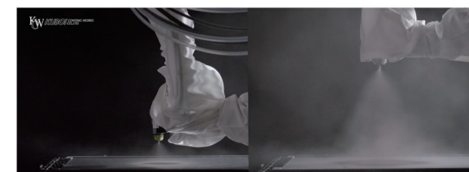
超高塗着塗装のスプレー状況(左)と一般塗装のスプレー状況(右)
