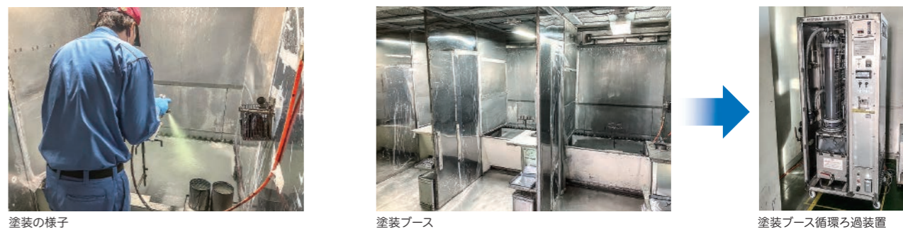
塗装の様子 塗装ブース 塗装ブース循環ろ過装置
