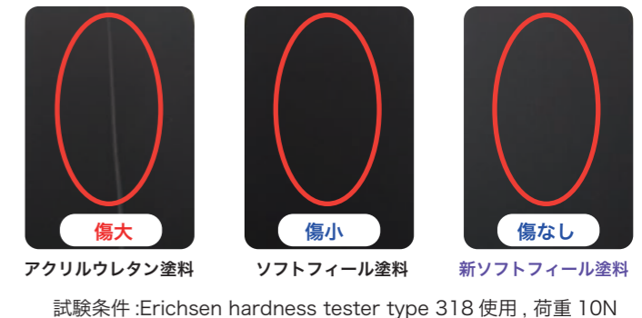
他社ソフトフィール塗料 当社ソフトフィール塗料 当社新ソフトフィール塗料 試験条件: 80°C95% 500H
